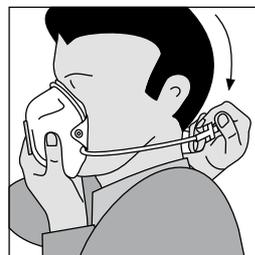
2. Die Maske am Kinn ansetzen und das untere Band über den Kopf bis zum Nacken nach hinten ziehen.
