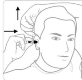
1. Greifen Sie sich über den Kopf und ziehen Sie Ihr Ohr leicht nach oben. Setzen Sie den Ohrstöpsel in den Gehörgang ein.
